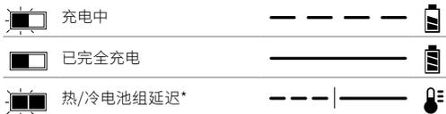
\*红色指示灯会继续闪烁，但黄色指示灯在本次操作过程中会亮起。电池组达到适当温度后，黄色指示灯会熄灭，充电器将恢复充电程序。
